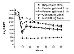
Abb. 4: Einfluss des Lüftungsverhaltens auf die CO<sub>2</sub>-Konzentration eines Innenraums
