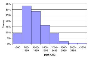
Abb. 2: Häufigkeitsverteilung der mittleren CO<sub>2</sub>-Konzentration in den untersuchten Schulen während des Unterrichtes
