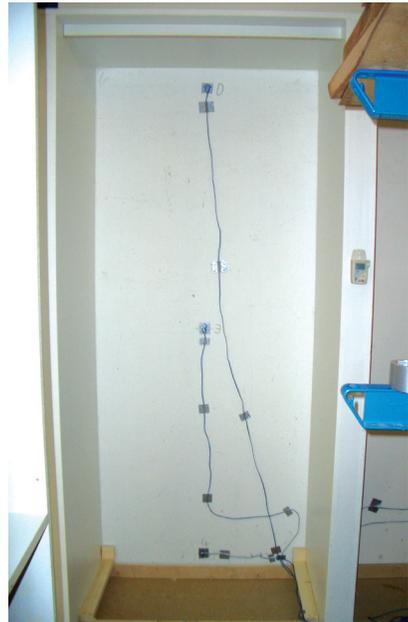
Abb. 8: Messstellen beim hinterlüfteten (links) und geschlossenen (rechts) Einbauschränk. Quelle: V. Hägele
